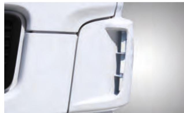
Дефлектор, направляющий поток воздуха ниже ручек дверей, обеспечивает их чистоту даже в сырую, дождливую погоду, отсекая поток брызг из-под колеса.
