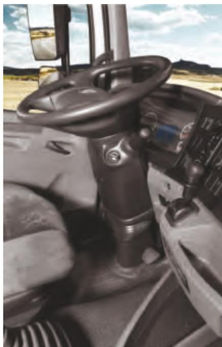
Мультифункциональное рулевое колесо имеет вспомогательные кнопки для управления различными функциями автомобиля. Переключатели справа отвечают за включение/выключение круиз-контроля, регулирование скорости автомобиля. Переключатели слева управляют информацией на дисплее панели приборов.
