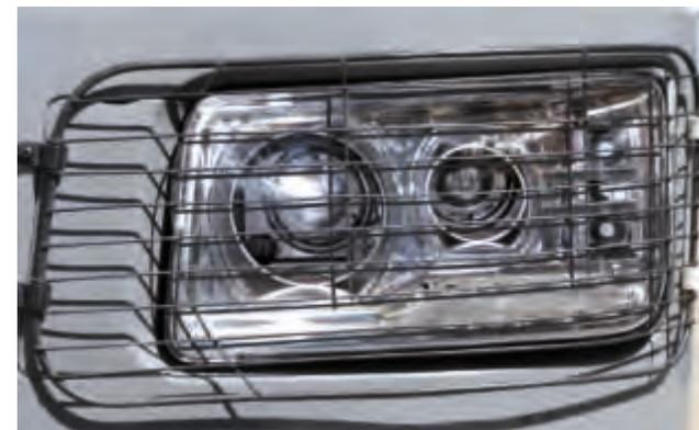
Система головного освещения с технологией LED – это дополнительное энергосбережение и большой ресурс. Стальные защитные решетки на фарах предотвращают повреждения вследствие ударов камней или гравия, способствуя таким образом снижению ремонтных расходов и повышению безопасности.
