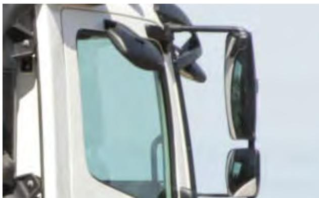
Зеркало для обзора тротуара, зеркало для контроля «слепой зоны» и система обогрева зеркал – это обеспечение безопасности движения.
