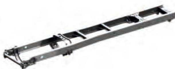
На автомобили всех типов устанавливается двойная рама (лонжерон в лонжероне), которая выполнена из высокопрочной стали с суммарной толщиной 16 мм.
