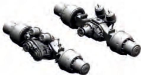
Автомобили комплектуются прочными ведущими мостами с планетарными редукторами, рассчитанными на осевую нагрузку 16 тонн.
