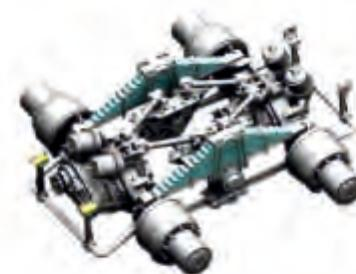
Чтобы выдерживать высокие нагрузки, автомобиль оснащен усиленной подвеской ведущих мостов.
